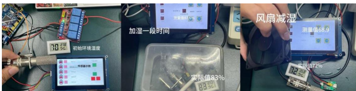
图 12：RS485 温湿度传感器测试
