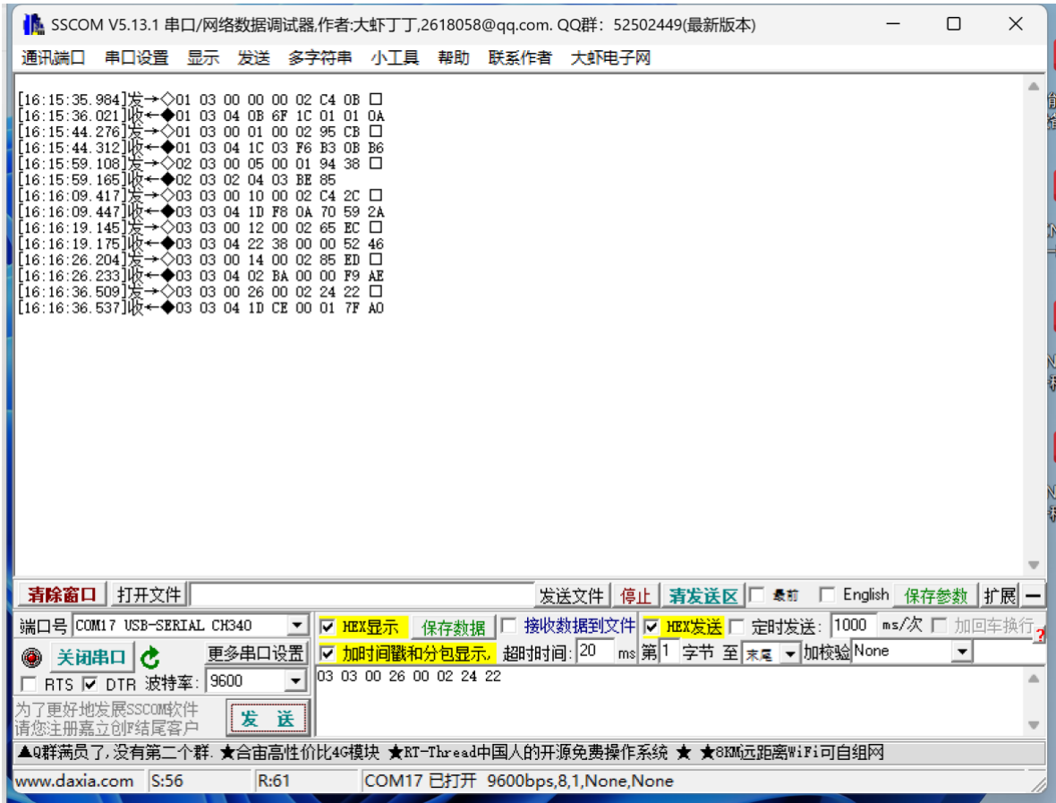
图 28:485 总线通讯测试实验图
