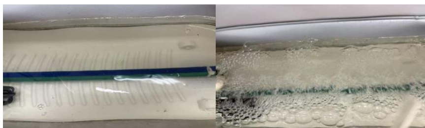
图 19: 增氧泵开关试验
